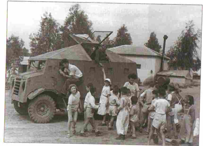
הצורך להגן על השיירות, עם המחסור של היישוב בציוד מלחמה, הובילו לניסיונות יצירתיים: כך למשל יוצרו משוריינים תוצרת ישראלית שנבנו על גבי שלדי משאיות, וכוננו 'משוריין סנדוויץ'. הם כונו כך משום שהם נבנו כסנדוויץ' - לוחות פלדה שהוצמדו משני צדי הרכב, שבמקרים רבים היה במקור רכב אזרחי רגיל. הוא כונה גם 'משוריין פרפר', עקב דמיונם של מכסי האזור שסגג לכנפי פרפר. בתמונה ילדי קיבוץ דורות שבנגב ליד משוריין פרפר שהכיא אספקה, פורים תש"ח.
